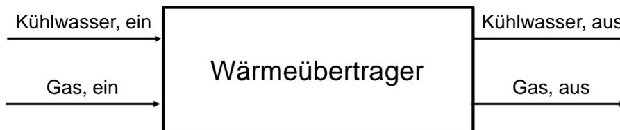
Bild 1.8: Schematische Darstellung eines idealen Wärmeübertragers. Bei der Anwendung des 1. Hauptsatzes ist zu beachten, dass nur Energieströme bilanziert werden, die über die äußeren Grenzen des Systems treten.
