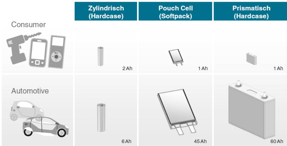
Bild 4.43: verschiedene Gehäuse und Verpackungstypen für Lithium-Ionen-Batterien [68]
