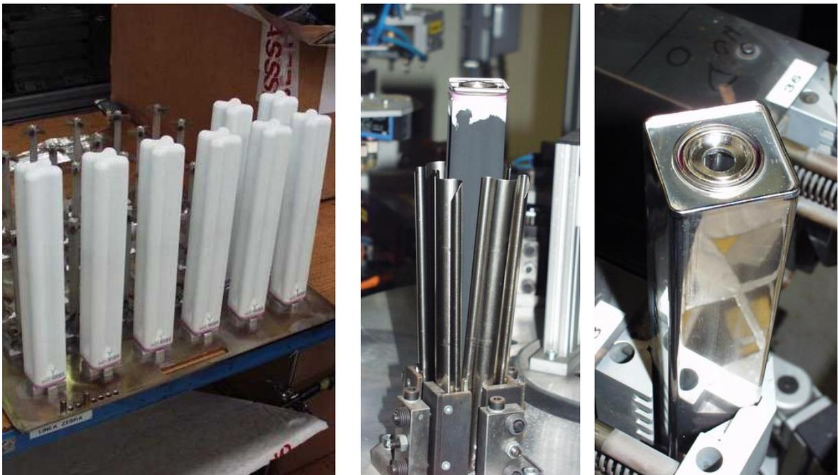
Bild 4.29: Fertigung der Zebra-Batterie: (von links) Kleeblatt-Elektrolyte, Aufbringen der Kapillarbleche, Zellbecher vor der Befüllung mit NaCl/Ni-Granulat, Quelle: MES-Dea
