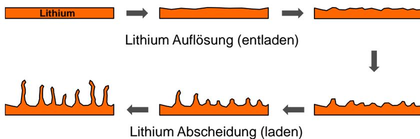
Bild 4.34: Veränderung der Oberflächenstruktur einer Anode aus Lithium-Metall während des Entladens und Ladens.
